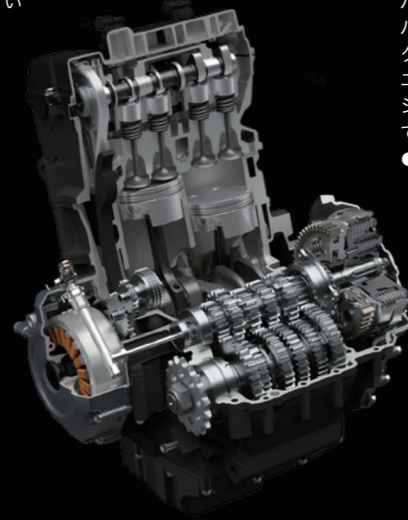
775cm 3 水冷4ストローク2気筒DOHC4バルブエンジン
